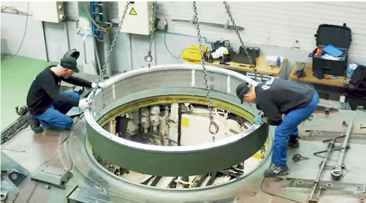
Colocação do novo anel na carcaça do veículo para receber a nova torre 3105. (Foto: John Cockerill)
