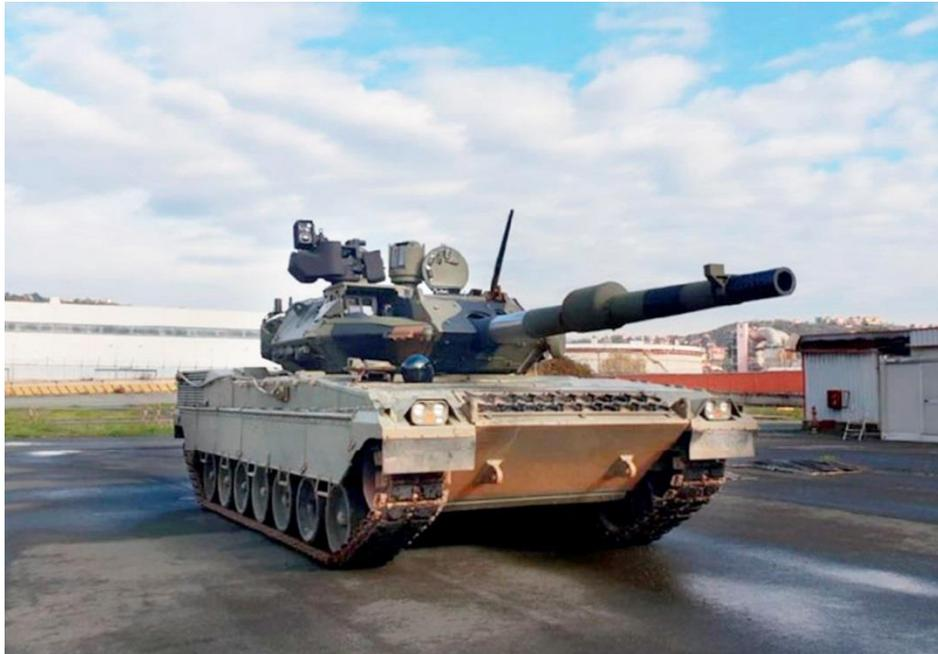
**Torre HITFACT MKII canhão de 120 mm instalada no Carro de Combate Ariete, lembrando que pode ser instalada no Carro de Combate Leopard 1 segundo o fabricante, inclusive com a opção de canhão de 105 mm. (Foto: Leonardo Defense Systems)**
