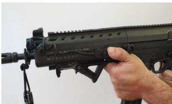
*Figura 23 - Empunhadura MagWell, lanterna com acionamento remoto*
